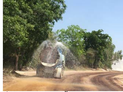
รูปที่ 2-10: การฉีดพรมน้ำบนเส้นทางลำเลียงแร่ ภายในโครงการ
